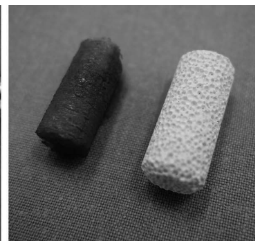
Рис. 21. Костный трансплантат и биокompозитный материал Syntricer
